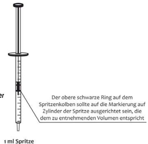
6. Führen Sie die Spritze mit Reagenz GH-2 in die Öffnung der Küvettenkappe ein. Drücken Sie die Taste **MEAS** und starten Sie die Titration, indem Sie **Reagenz GH-2** vorsichtig in kleinen Portionen (tropfenweise) hinzugeben. Wenn der Endpunkt der Titration trotz Zugabe des gesamten Volumens der Spritze nicht erreicht wird, entnehmen Sie eine weitere Portion (1 ml) Reagenz GH-2 und setzen Sie die Titration fort.
