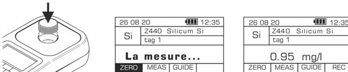
Il est possible d'afficher le résultat dans des unités alternatives : ppm et  $\text{SiO}_2$  mg/l. Le changement des unités peuvent être effectués par le clavier en utilisant le curseur **gauche/droite** .
